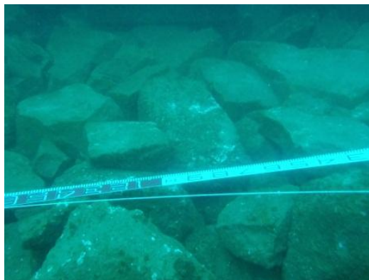
写真-2.2.1 捨石マウンド表面調査の例 1)
