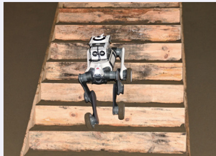
貫通確認へ向かう四足歩行ロボット
