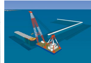
▶ICTを活用した鋼板セル据付施工管理画面
