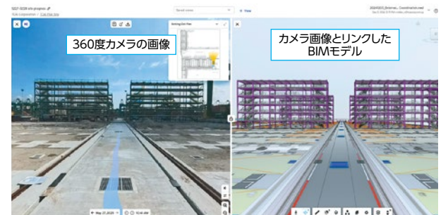
360度カメラとAIを活用したDX施工管理ツールの採用
