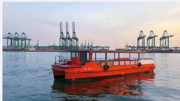
シンガポールの建設現場では初導入のEVボート
