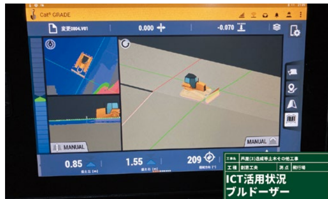
ICTブルドーザ搭載の3Dマシンガイダンス画面
