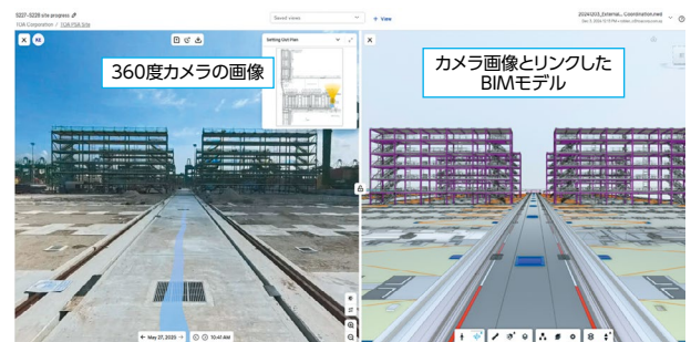
360度カメラとAIを活用したDX施工管理ツールの採用
