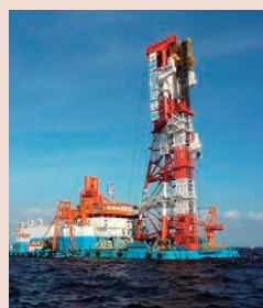
深層混合処理船「黄鶴」
