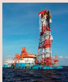
深層混合処理船「黄鶴」
