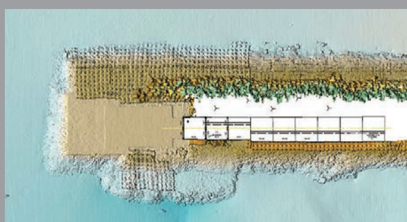
マルチビーム測量による防波堤築造工事出来形図
