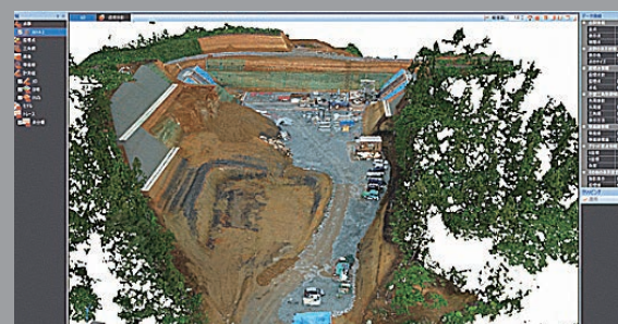
UAV写真測量データを用いた陸上工事現場の3次元モデル
