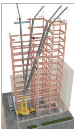
BIMによる鉄骨建て方の検討
