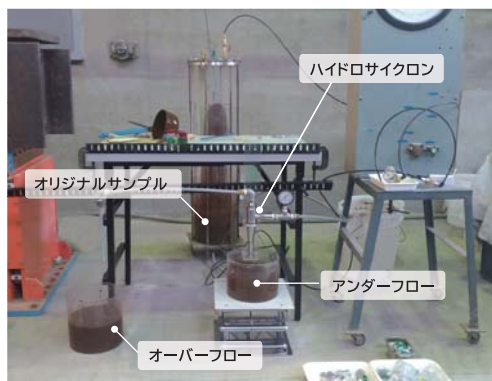
ハイドロサイクロンを用いた分級試験の様子
