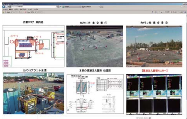
Webカメラ等の活用により施工情報を「見える化」
