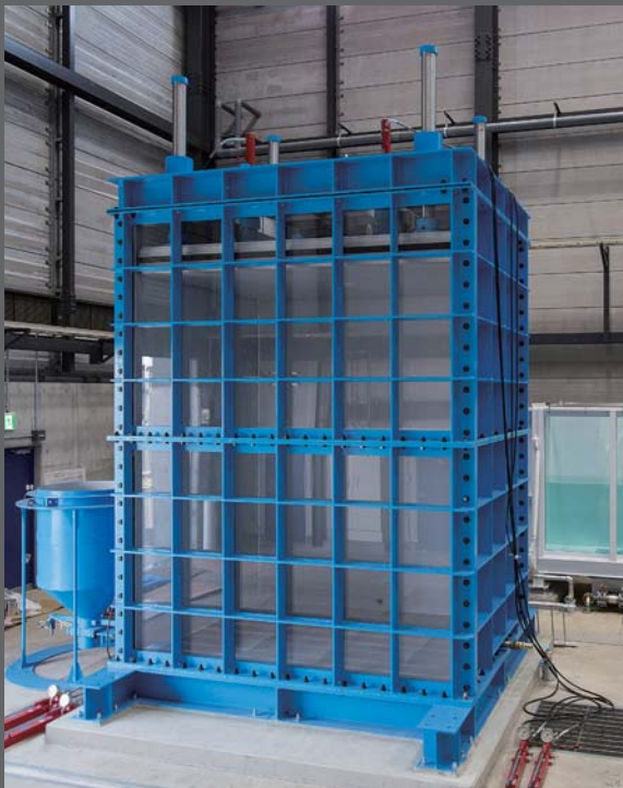
大型実験用土槽 4mの高さを誇る国内有数の実験用土槽。実機を用いた試験が困難な場合や、実験条件を明確にコントロールしたい場合に、実際に近い実験ができます
