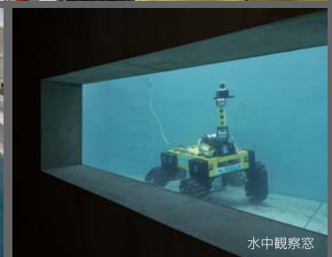
施工実験水槽 幅11.4m×奥行4.0m×深さ5.0mの巨大水槽は、水中作業ロボットの作動実験や各種の施工実験をはじめ、水中における施工状態の再現などを可能にしました
