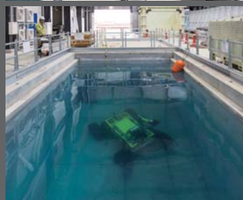
施工実験水槽 幅11.4m×奥行4.0m×深さ5.0mの巨大水槽は、水中作業ロボットの作動実験や各種の施工実験をはじめ、水中における施工状態の再現などを可能にしました
