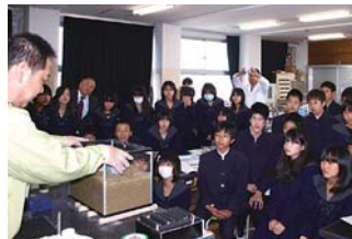
液状化現象の模型実験
