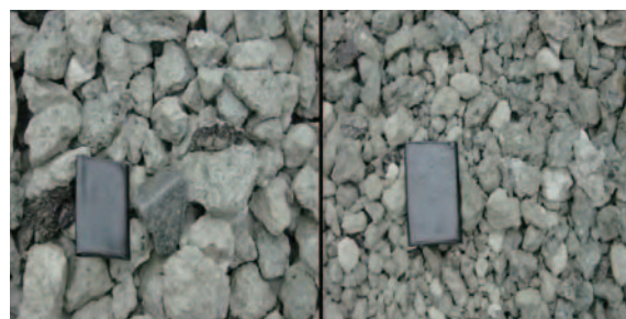
海洋コンクリート殻から製造された再生骨材
