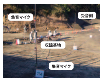
実際の施工に本システムを適用した例（実測値と計算値が合致）
