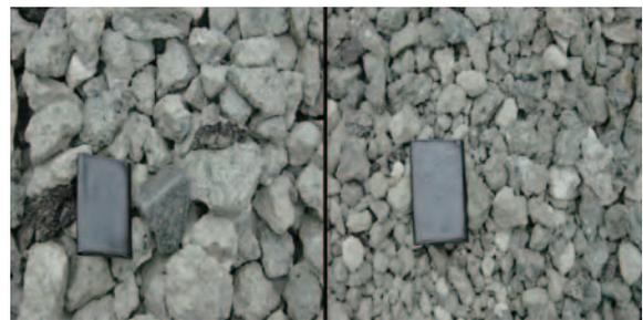
海洋コンクリート殻から製造された再生骨材
