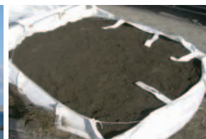
実験材料(ダム湖浚渫土砂)
