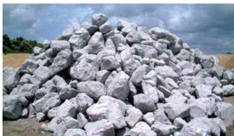
鉄鋼スラグ水和固化体製人工石材
