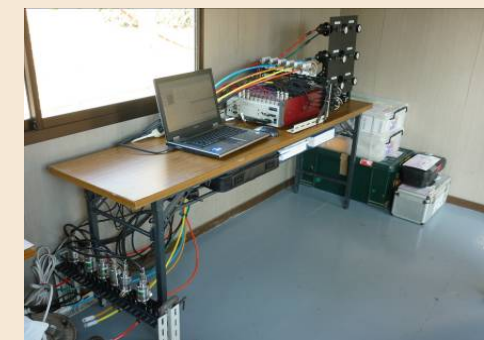
圧力計、流量計にて空気を計測し、減圧弁にて所定条件に制御します。
